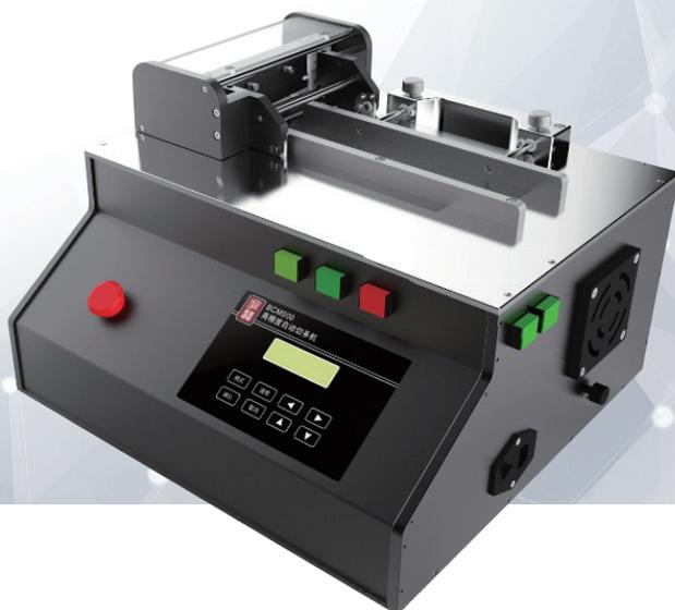
BCM500 型高精度自动切条机采用步进电机驱动机械结构有效精准控制进料宽度，高速高扭矩电机驱动切刀组件配合进料部件快速斩切物料，运行速度快，切割精准，能有效降低人工成本，提高工作效率。本设备具有进料护板可调节，斩切宽度可调节，斩切速度可调节等多项功能，能实现多种规格试纸条的斩切操作，广泛应用于体外诊断领域中各种规格试纸条的快速斩切操作。
