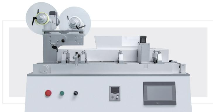
TM1000 贴膜机的生产过程由手动撕膜、自动贴膜和辅料斩切三道工序组成。通过手动投送已撕掉隔离纸的胶板，利用输送带传送完成对卷式辅料的连续粘贴，最后完成物料粘贴的胶板经自动斩切为制定长度，适合具有一定规模的层析试纸生产企业。
