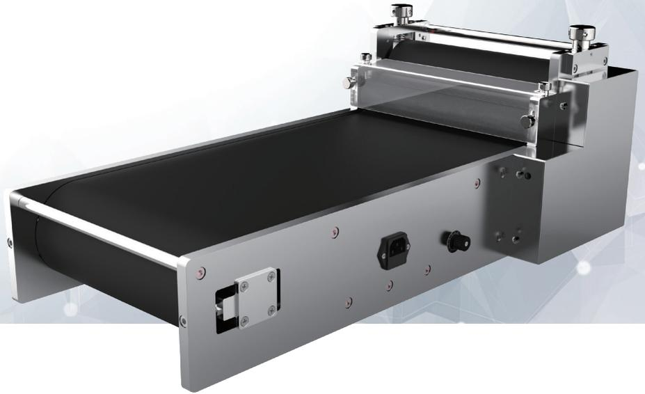
PSM200/PSM300 型压壳机采用机械压紧方式对预装检测卡壳进行快速压合，降低人工成本，提高工作效率。放置在输送带上的预装卡壳经输送带到达预压辊、压合辊，经过预压、压合两次不同高度的压合操作，使检测卡壳压合牢固、可靠。PSM200/PSM300 型压壳机广泛应用于体外诊断领域中各种规格检测卡壳的快速压合操作。
