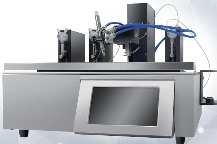
XYZ3000 喷金划膜一体机采用高精度步进泵进行液体输送，可实现无脉冲液流控制，保证在膜上形成均匀单一的溶液线条。进行划膜所采用的聚酯中空纤维管具有很好的强度及良好的柔韧性。在划膜时既能保证线条的质量，又能保证不损伤膜表面结构，喷金需要外界高压起源驱动。
