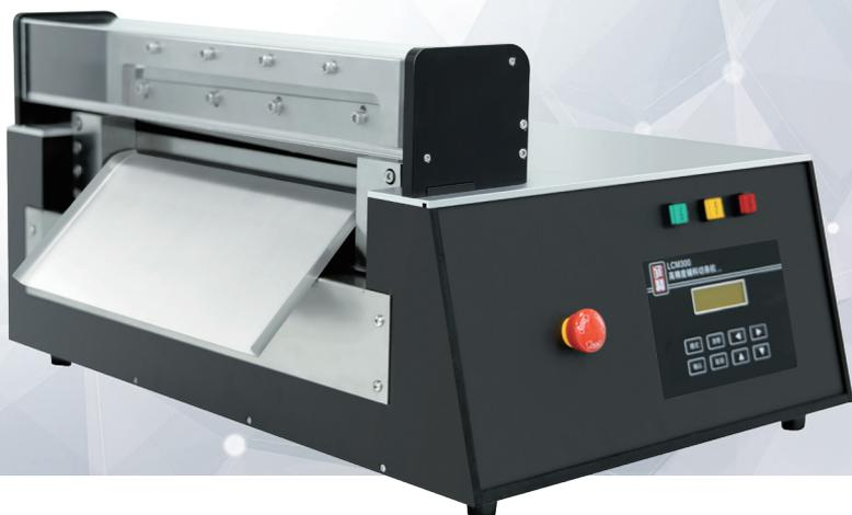
LCM300 宽型辅料切割机采用步进电机驱动机械结构有效精准控制进料宽度，高扭矩步进电机驱动切刀组件配合进料部件快速斩切物料，运行速度快，切割精准，能有效降低人工成本，提高工作效率。本设备具有进料护板可调节，斩切宽度可调节，斩切速度可调节等多项功能，能实现多种规格辅料的斩切操作，广泛应用于体外诊断领域中宽型辅料的快速斩切操作。
